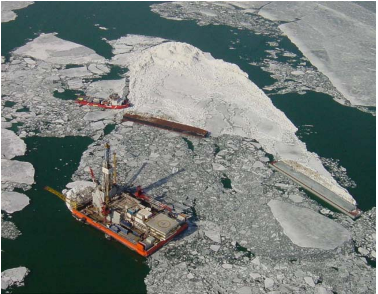
Bohranlage mit Eisbarrieren
