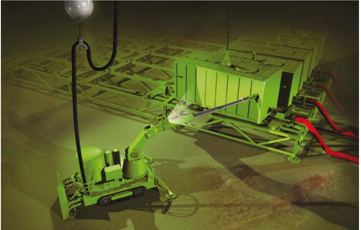
Unterwasserproduktionsanlage für Öl und Gas (ISUP) für große Tiefen oder bei temporärer Eisbedeckung
